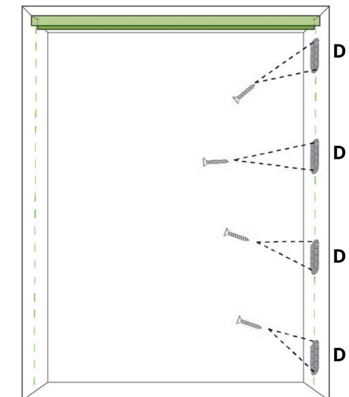
5. Sur le côté opposé, aligner verticalement les 4 autres plaques (D)\* et vérifier que celle-ci soit bien en face des autres. Puis, visser les.
